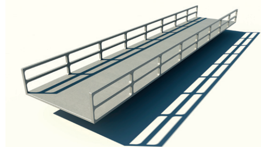
Nieuw concept UHSB- brug met betondruksterkte van 800 N/mm 2
